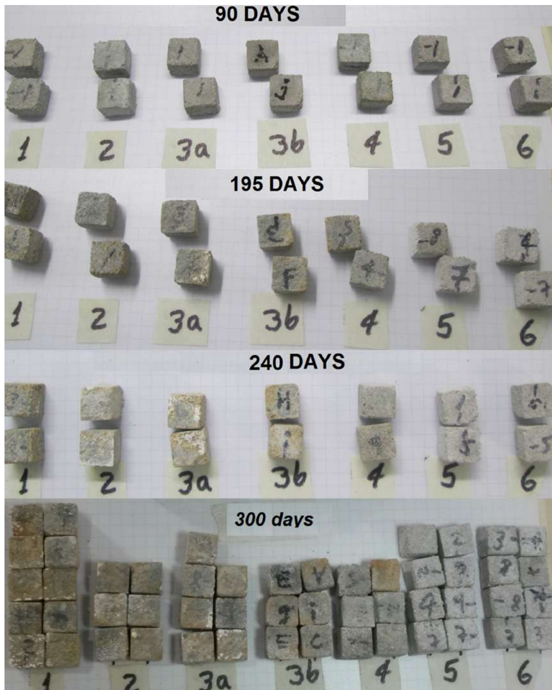
Figure 4.5: Exposed samples inoculated in aseptic conditions: 1) H. n., 2) A.t., 3a) H.n.+A.t., 3b) H.n.+A.t.+Triclosan, 4) H_2S , 5) Control, 6) Non-carbonated
